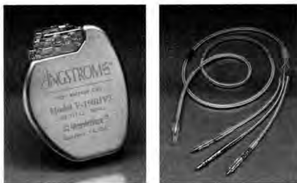
Obr. č. 2 – Implantabilní kardioverter-defibrilátor a defibrilační elektroda
