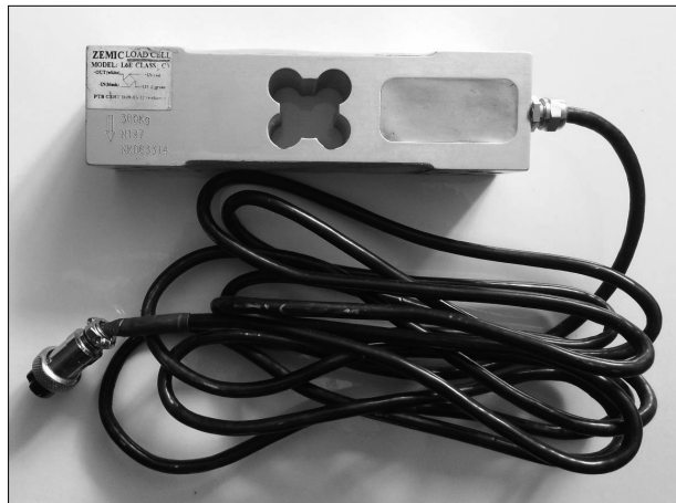
Obr. 1: Tenzometrický snímač Zemic model L6E C3 load cell.
