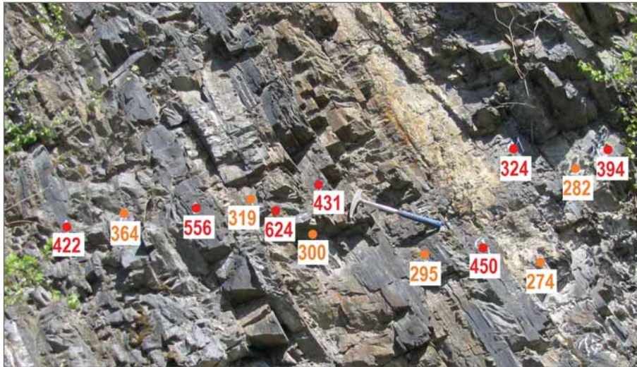
Obr. 4: Střídání siltovců a drob hornobenešovského souvrství ve valšovském lomu. Místa odběru vzorků: červené body = siltovce, oranžové body = droby. Uvedené hodnoty hmotnostní aktivity ekvivalentu ^{226}\text{Ra} ( a_m ) jsou uvedeny v \text{Bq}\cdot\text{kg}^{-1} .
