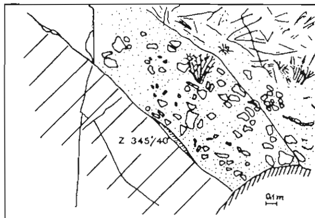
Obr. 4 Tektonický kontakt zpevněného vápenného, brekciového pískovce s granodiority brněnského masivu, v zářezu trati u žel. zastávky Ivančice-letovisko.
