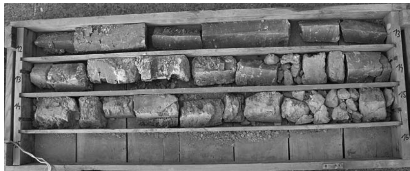
Obr. 2: Navětralé vápnité nazelenalé prachovité jíly až jílovité prachy karpatu (vrt J-2). Fig. 2: Weathered calcareous greenish silty clays to clay silts of the Karpatian (J-2 borehole).
