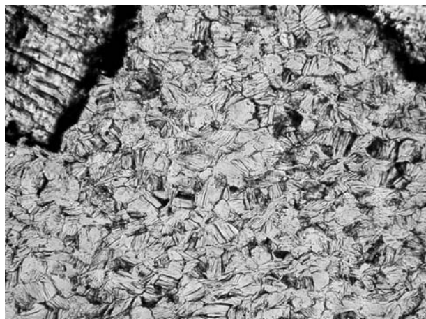
Obr. 1: Jílová hmota ze Zlatého dolu ve výbruse. V horních rozích snímku zachyceny krystaly dolomitu povlečené limonitem. Polarizované procházející světlo, spodní strana snímku měří 0,5 mm.
