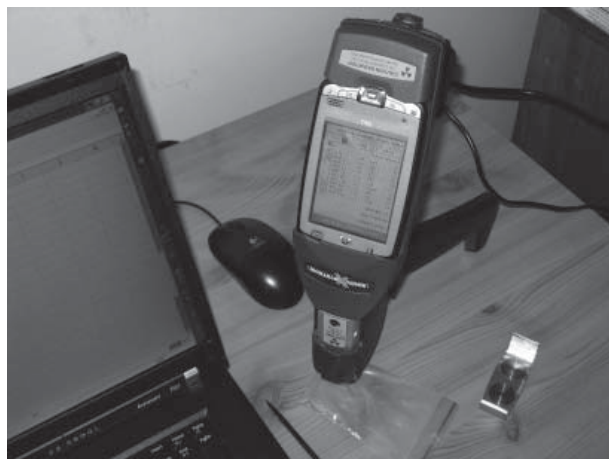
Obr. 1: Rentgen-fluorescenční spektrometr, model Alpha, Innov-X Systems, Inc., Česká geologická služba.
