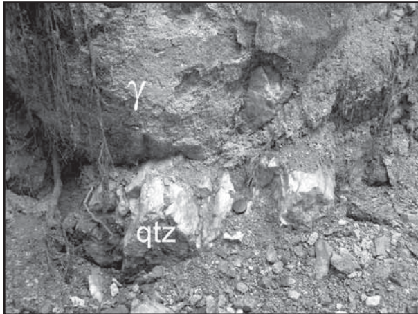
Obr. 1: Kontakt žilného křemene (qtz) s okolní alterovanou horninou ( \gamma – granit) v povrchových dobývkách u Velké Kraše. Fig. 1: Contact zone of vein of quartz and altered rock ( \gamma – granite) at abandoned mining pits near Velká Kraš.
