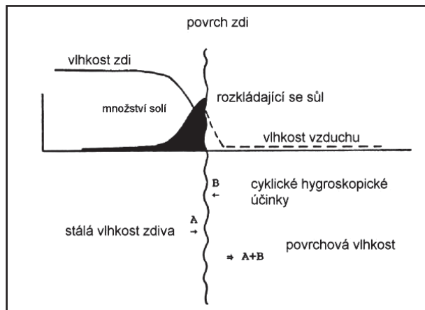
Obr. 2: Základy zvětrávání budov solemi (upraveno podle Tennikatové 1992).
