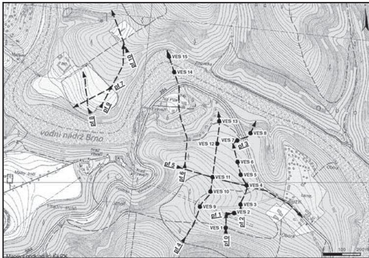
Obr. 1: Přehledová mapa průběhu georadarových profilů a pozice sond VES. Fig. 1: Localization of georadar survey line and vertical electrical sounding in the study area.
