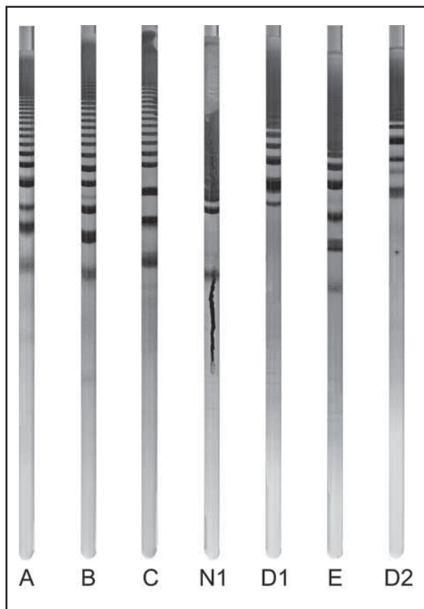
Obr. 1: Páskované vzory v kolonách. Kolona N1 vykazuje nehomogenitu v gelu. Kolony D1 a D2 obsahují stejné množství látek, ale vývoj vzorů probíhá odlišně. Ve všech kolonách je možné rozlišit přítomnost reagentů podle jejich barev: žlutá – chroman, světle modrá – iony mědi.
