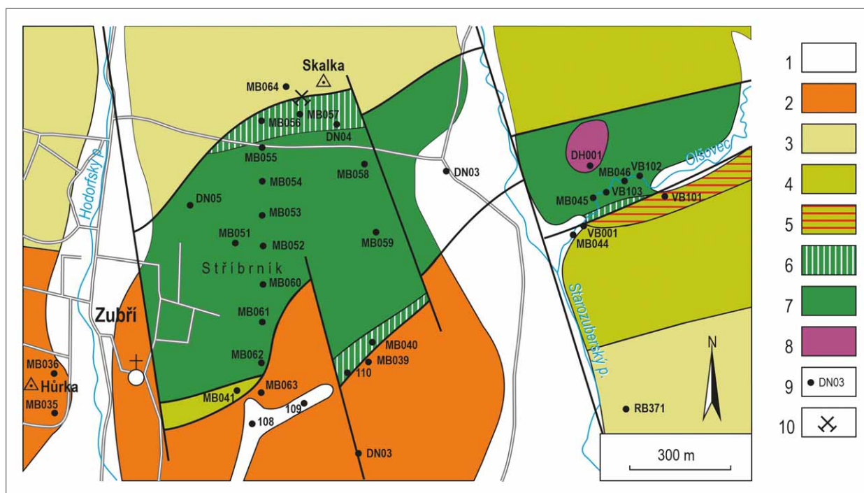
Obr. 1: Geologická mapa okolí Stříbrníku v Zubří. 1 – fluvialní a deluviofluvialní kvartérní sedimenty, 2 – rožnovské souvrství, 3 – ístebňanské souvrství, 4 – godulské souvrství, 5 – mazácké souvrství, 6 – lhotecké souvrství, 7 – hradištské souvrství, 8 – horniny těšinitové asociace, 9 – dokumentační bod, 10 – staré důlní dílo (halda).
