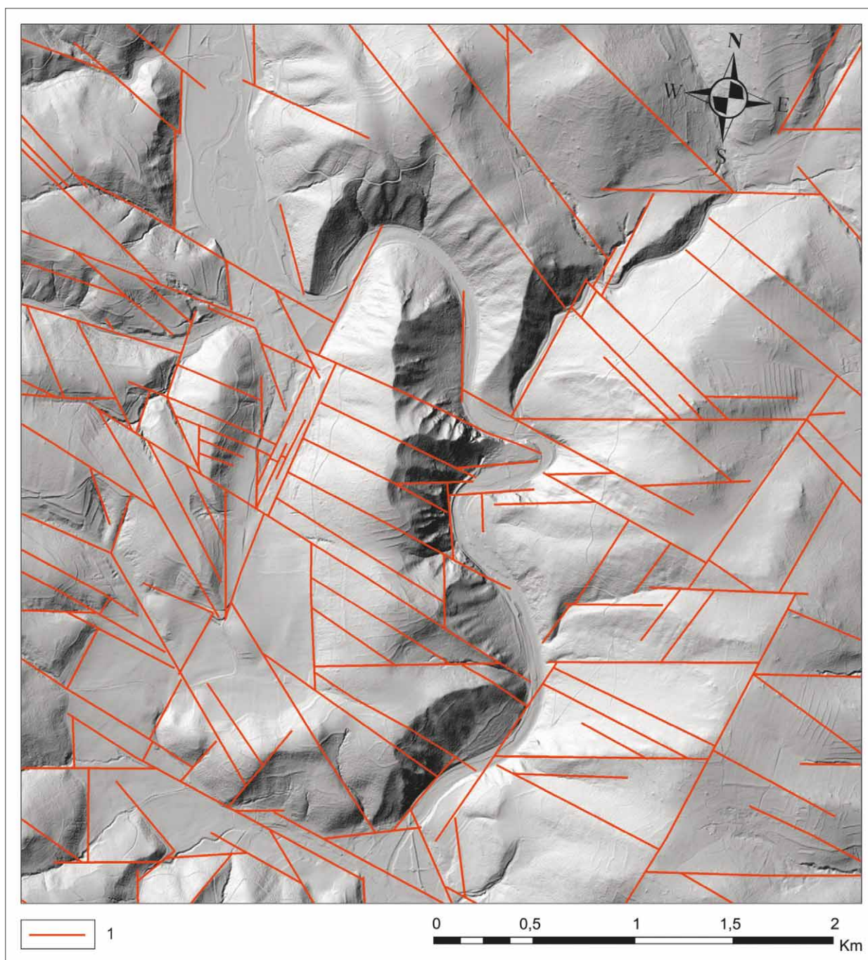
Obr. 2: Výsledná síť morfolineamentů (červené linie – 1) vstupující jako podklad tvorby 3D modelu detailního území. Fig. 2: The resulting network of morpholineaments (red lines – 1) is a basis for creating a 3D model of the detailed area.
