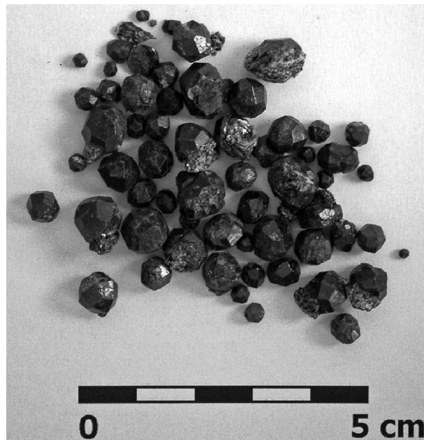
Obr. 5: Almandinový koncentrát použitý na experiment. Foto M. Hložek. Fig. 5: Sample of almandine concentrate used for the experiment. Photo by M. Hložek.
