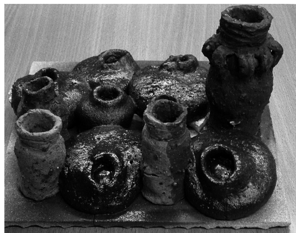
Obr. 6: Miniatury loštických pohárů po výpalu v oxidační peci při teplotě 1 250 °C. Roztavené jsou poháry zhotovené ze spraše. Fig. 6: Miniatures of the Loštice pottery after the firing in oxidation furnace at the temperature of 1 250 °C. The melted tumblers have been made of loess.
