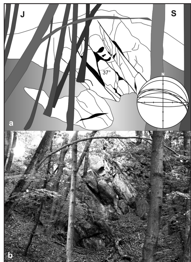
Obr. 1: Diskontinuity v deformovaném trachyandezitu a) interpretace, b) fotografie se strukturálním měřením (spodní plocha Lambertovy projekce).
