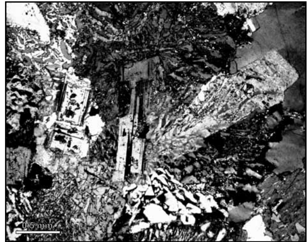
Obr. 2: Příklad granofyrické struktury ve vzorku BH038, zkřížené nikoly.
