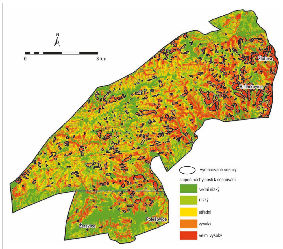
Obr. 4: Výsledná mapa náchylnosti k sesouvání s vyznačenými sesuvy. Velmi nízký stupeň náchylnosti k sesouvání – hodnota 0; nízký stupeň náchylnosti k sesouvání – interval hodnot 0–0,02745098; střední stupeň náchylnosti k sesouvání – interval hodnot 0,02745098–0,070588235; vysoký stupeň náchylnosti k sesouvání – interval hodnot 0,070588235–0,149019608; velmi vysoký stupeň náchylnosti k sesouvání – interval hodnot 0,149019608–1.
