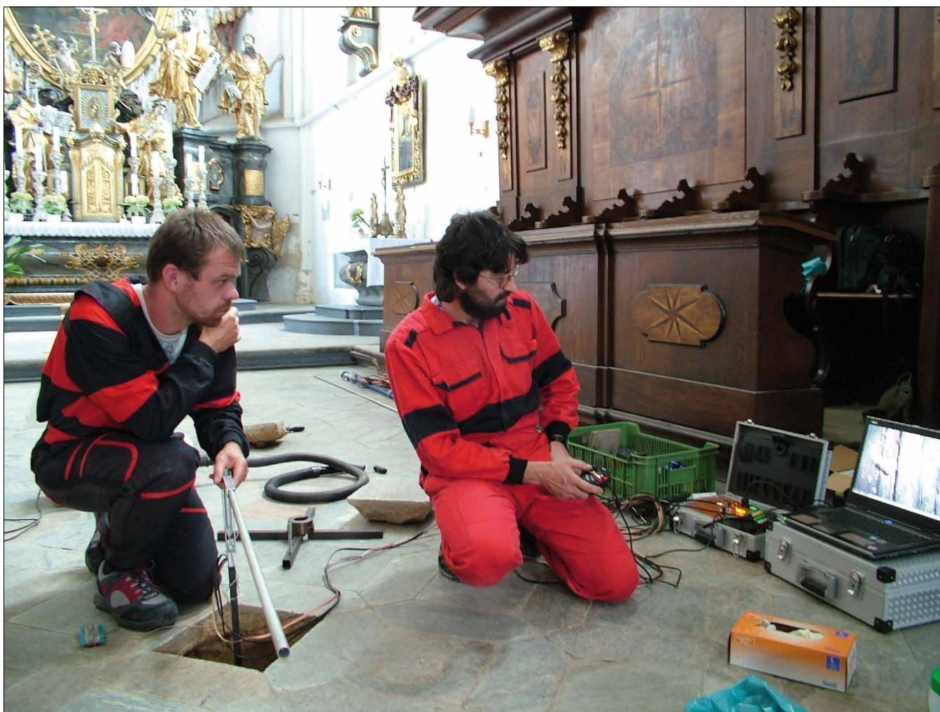
Obr. 3. Průběh vizuálního průzkumu minikamerou (Geo-cz).
