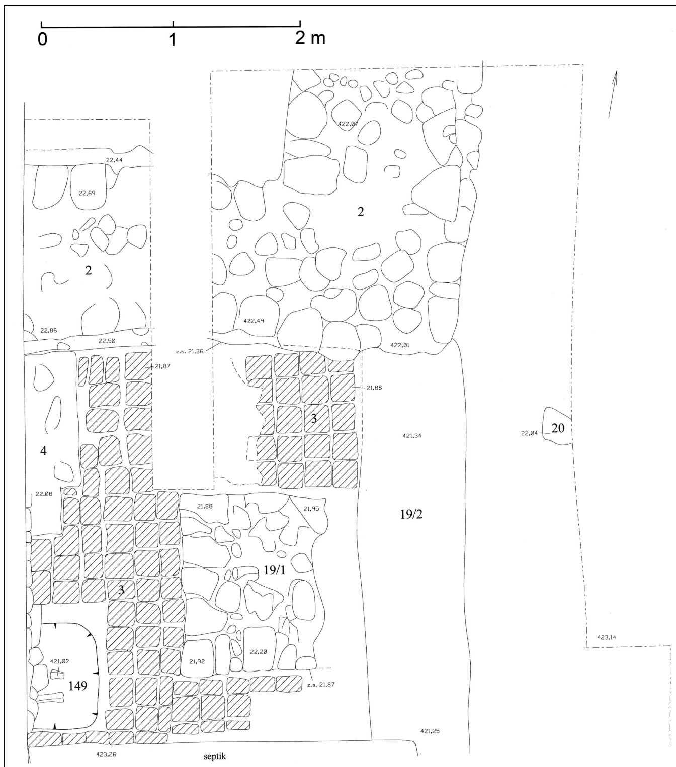
Obr. 72 . Celková situace v S.I/07, III/08 a XVII/12 v níž zachycena část pohřební kaple přistavěné k jižnímu zdivu kněžiště raně gotického kostela. Jihovýchodní nároží raně gotického kostela (2), kamenná substrukce (4), dlažba (3), substrukce oltární menzy (19/1), negativ zdiva (19/2), západní část hrobu 149 a kámen (20).
