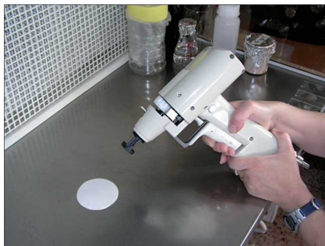
Obr. 8. Jak se přenášejí geny: částicové dělo pro přenos DNA pomocí zlatých či wolframových minipartikulí.
